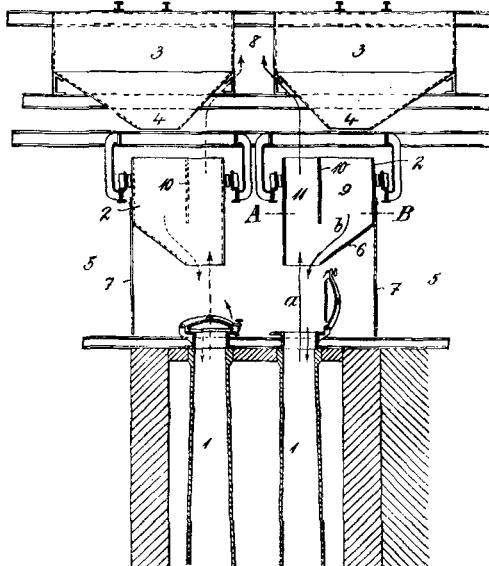
weichenden Gase, dadurch gekennzeichnet, daß einerseits das seitliche Entweichen der Gase nach der Ladeflur (5) durch eine auf der Rückseite der Ladebehälter (2) angeordnete, bis dicht an den Boden der Ladeflur heranreichende Schutzwand (7) gehindert, andererseits das Emporsteigen der Gase durch einen schlottartig wirkenden Schacht (8) befördert wird, welchen die oberhalb zweier Retorten (1) oder Retortenreihen im Abstande voneinander angeordneten Kohlenbehälter (3) seitlich begrenzen.
