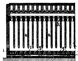
kanal bei Verlegung der Gasdüsen innerhalb der Luftzuführung, dadurch gekennzeichnet, daß die Gasdüsen innerhalb von Mischdüsen für Luft und Gas aus der Mischdüsenöffnung herausziehbar liegen. —
