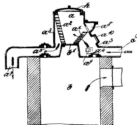
2. Ausführungsform des Gaserzeugers nach Anspruch 1, dadurch gekennzeichnet, daß im Fülltrichter auf der einen Seite ein steiler, auf der anderen Seite ein milder Rost angeordnet ist, um beim Herablassen der Kohle in den Schacht des Gaserzeugers auf dem milder steilen Rost etwas glühende Kohle zurückzuhalten. —
