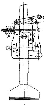
Gleitschlitten, bei welcher eine Klemmvorrichtung durch Auftreffen eines Hebels gegen obere und untere Anschläge abwechselnd geschlossen und geöffnet wird, dadurch gekennzeichnet, daß der in dem Schlitten gelagerte Anschlaghebel einen Teil einer Kniehebelverbindung bildet, welche beim Beugen des Knies infolge Auftreffens des Anschlaghebels gegen einen unteren Anschlag durch eine Feder zusammengezogen wird und die Stampferstange im Schlitten einklemmt, beim
